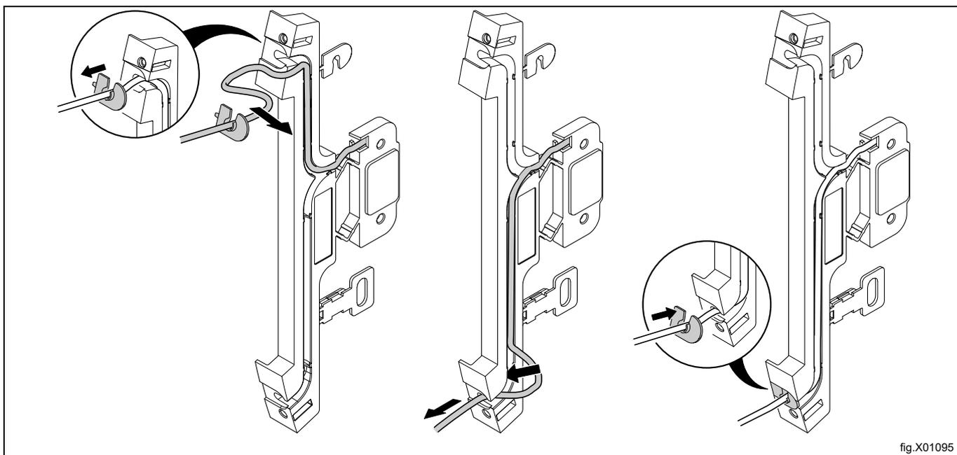
Capovolgere la staffa dell'interruttore a lame e montarla sul lato destro. Estrarre il cavo dell'interruttore dello sportello attraverso il foro e collegarlo.
